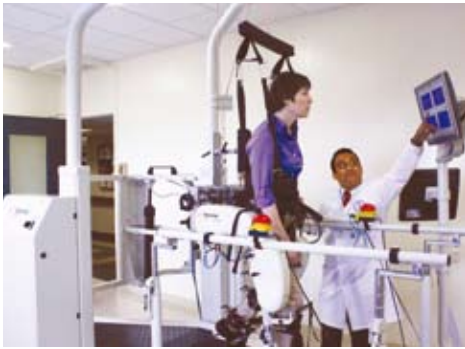
Lokomat, aan de universiteit Twente ontwikkeld exoskelet voor fysiotherapie doeleinden.
